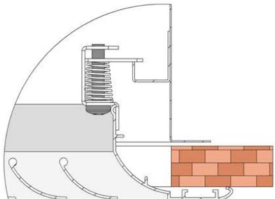
\*Standart olarak 12-22 mm kalınlığındaki alçıpan tavanlar için tasarlanmıştır. Diğer kalınlıklardaki tavanlar için sorunuz.
